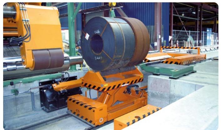
**SCISSOR LIFT TABLE, SHOULDERED BY THE ATLAS WHEEL BLOCK SYSTEM**
