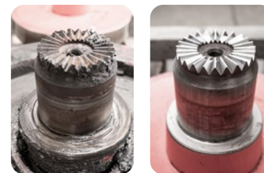
Beispielhafte Instandsetzung einer Verzahnung
