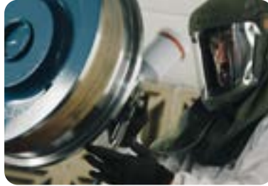
Çevre kirliliğinin önemli ölçüde azaltılmak için emme düzeneğine ve filtre sistemine sahip yeni boyama tesisi
