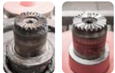
Beispielhafte Instandsetzung einer Verzahnung
