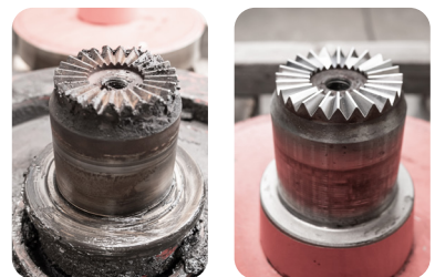
Voorbeeld van een reparatie van een tandwieloverbrenging
